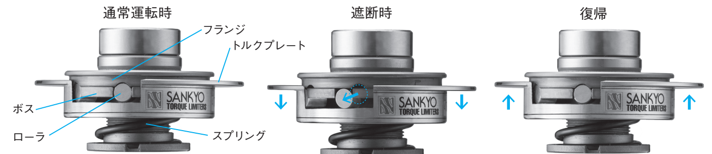
フランジタイプ作動仕組み
